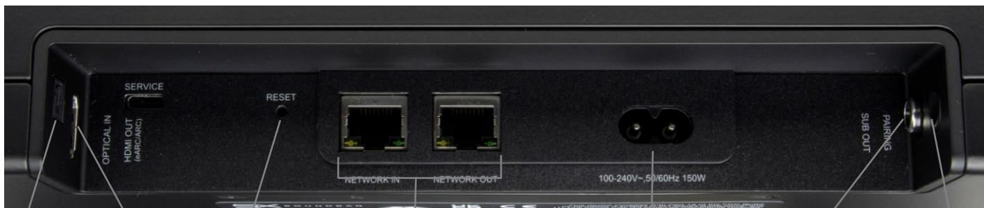
Оптический HDMI eARC Кнопка сброса ETHERNET входы POWER CONNECTION LFE выход кнопка сопряжения
